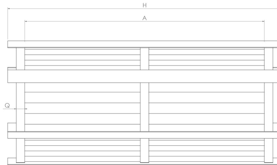
Particolare interno al raddrizzatore di flusso
