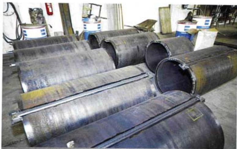
Alcuni giunti di saldatura eseguiti con procedimento ad arco sommerso.
