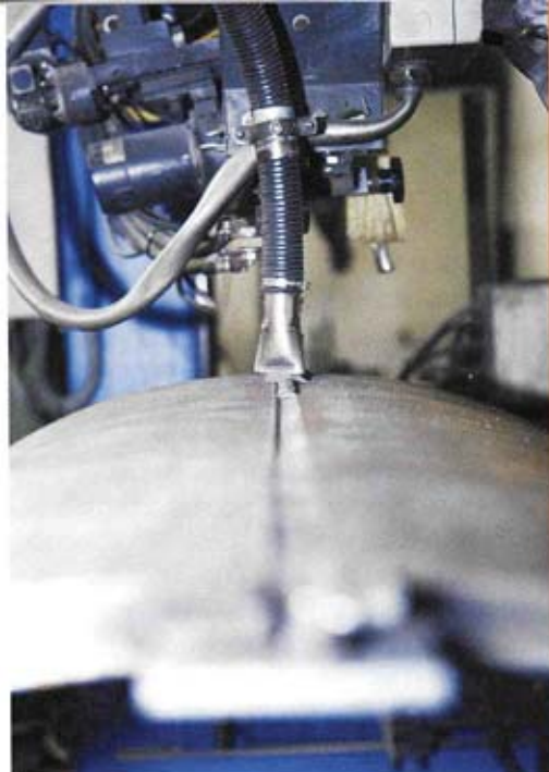
Dettaglio di saldatura con procedimento ad arco sommerso eseguito presso Fulgosi.
