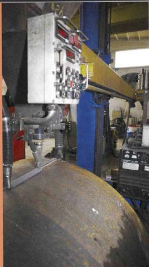
Fulgosi adotta manipolatori Saf-FRO MH di varie dimensioni con teste Arco Sommerso Subarc3.
